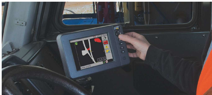
Arriba, pantalla del Proximity Awareness en la cabina del camión. (Foto: Caterpillar)
