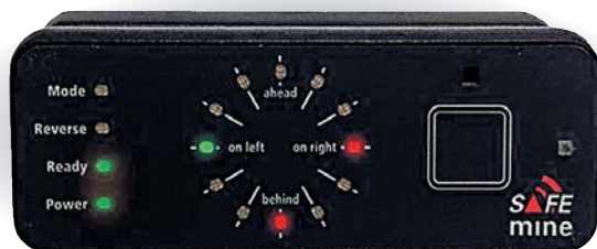
Рис. 1 Светодиодный дисплей, показывающий положение и удалённость окружающих транспортных средств (зелёный индикатор указывает на ТС слева на удалённости в 100 м; красный индикатор указывает на ТС, находящиеся справа и сзади на удалённости 50 м)
